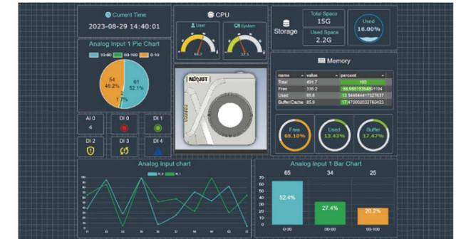
VIC-Flow包括一个整合式仪表盘,具有直接显示、步骤图、折线图、仪表、按钮、指示器和各种其他显示界面。这使您能够轻松建立简化版战情室,而无需PC或服务器。
